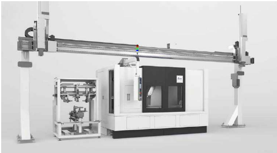
Maschine mit Portal zur Beladung von oben und externe Messstation
